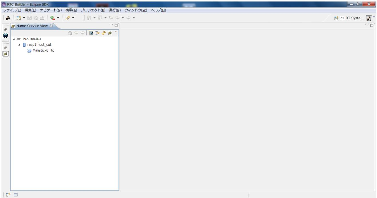
次に、Kobuki に接続した Raspberry Pi に接続します。接続ダイアログに Kobuki に接続した Raspberry Pi の IP アドレス、または、ホスト名を入力します。
