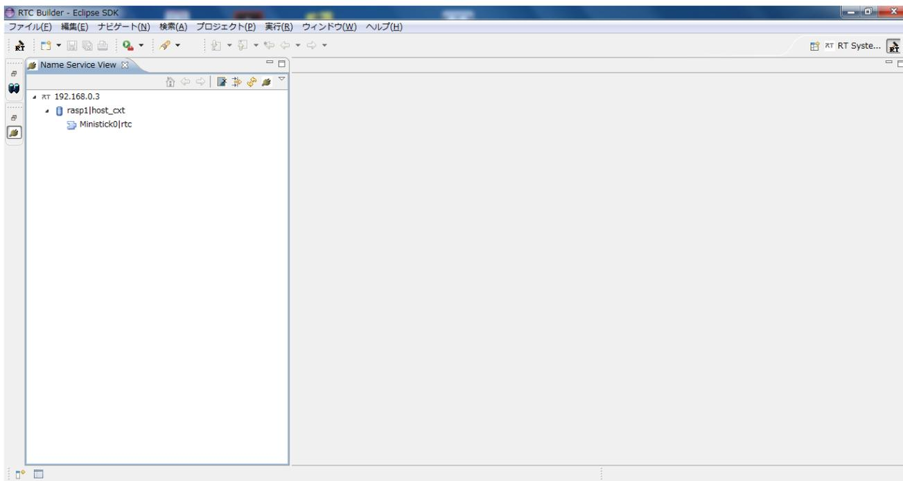
次に、EV3 のネームサーバへ接続します。再度 NameService View の接続アイコンをクリックし、EV3 に表示されている IP アドレスをダイアログに入力します。
