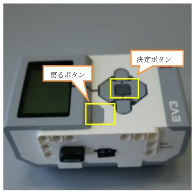
しばらくすると ev3dev が起動して画面にメニューが表示されます。表示されずにずっと boot の状態が続くときは[戻るボタン][決定ボタン][左ボタン]を同時に数秒間押し続けてください。強制的に再起動になります。
