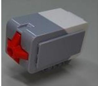
タッチセンサーとはボタンが押されたか離れたかを検知することが出来るセンサーです。EV3 のタッチセンサーは左の写真の物になります。この超音波センサーを EV3 に接続することによりタッチセンサーを使用することが出来るようになります。
