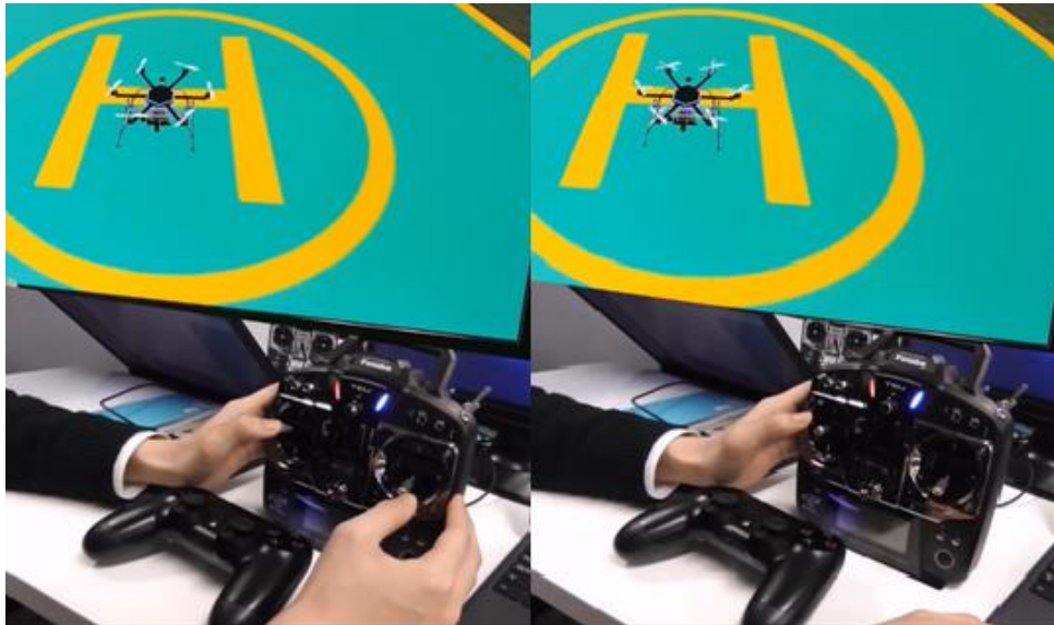
図 6-16 Armed 切り替え操作中(左)と Armed 切り替え完了(右)
