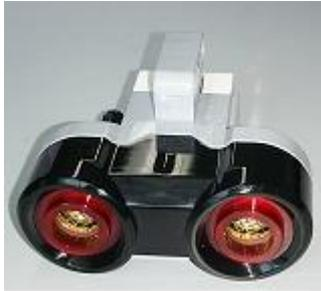
超音波センサーとは超音波を対象物に向け発信し、その反射波を受信することにより、対象物の有無や対象物までの距離を測定するセンサーです。EV3の超音波センサーは左図となります。この超音波センサーをEV3に接続することにより超音波センサーを使用することが出来るようになります。
