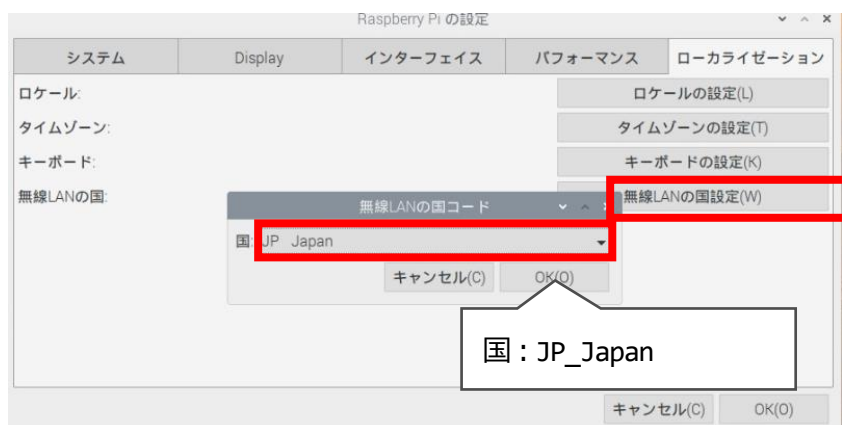
図 3-5 Raspberry Pi 無線LANの国設定
