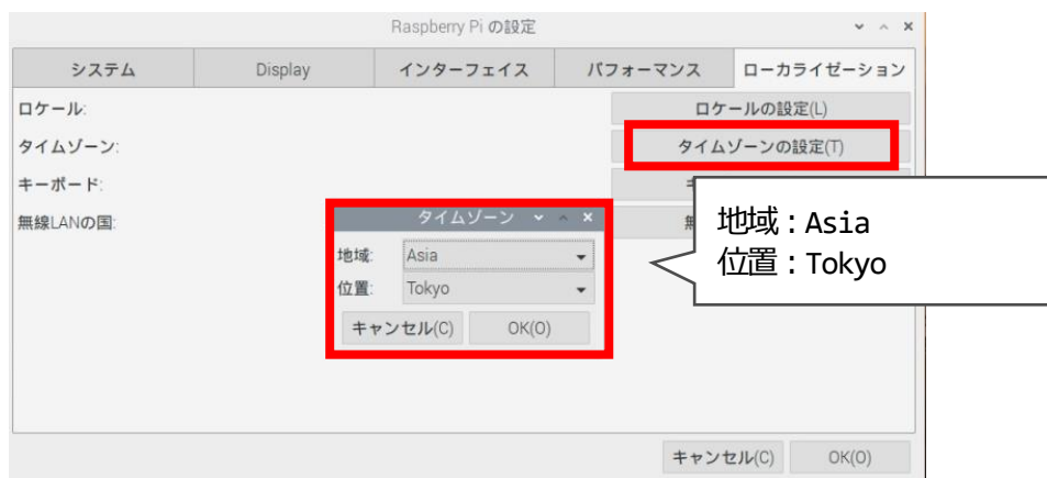
図 3-4 Raspberry Pi 設定タイムゾーン設定
