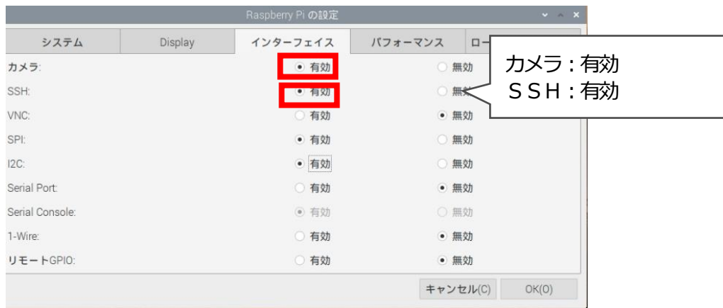
図 3-3 Raspberry Pi 設定インターフェイス画面
