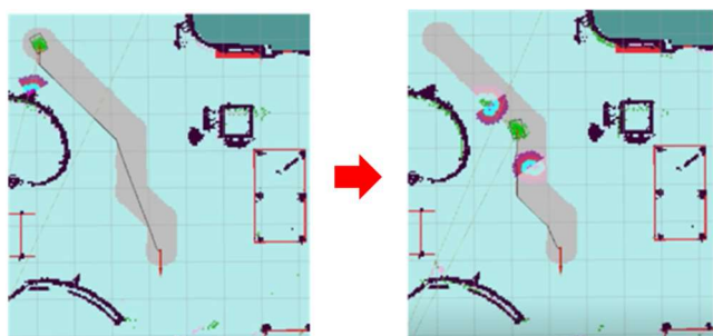
Fig.17. 動的障害物の回避のため再計画された局所経路
