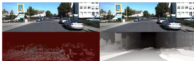
図5 動画における one shot の RGB の frame 画像 (左上上半分) とこの frame において Lidar によって計測された距離の明暗 (256 階調) 画像 (左下半分) と、動的視差法による距離画像 (右下半分) を示す。
