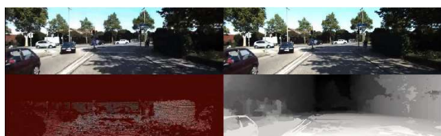
図4 動画における one shot の RGB の frame 画像 (左上上半分) とこの frame において Lidar によって計測された距離の明暗 (256 階調) 画像 (左下半分) と、動的視差法による距離画像 (右下半分) を示す。
