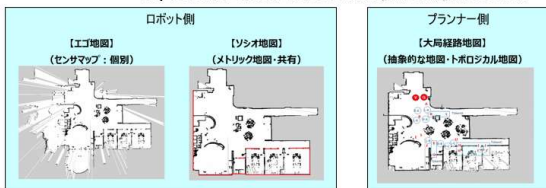
Fig. 7. 階層化された地図構造
