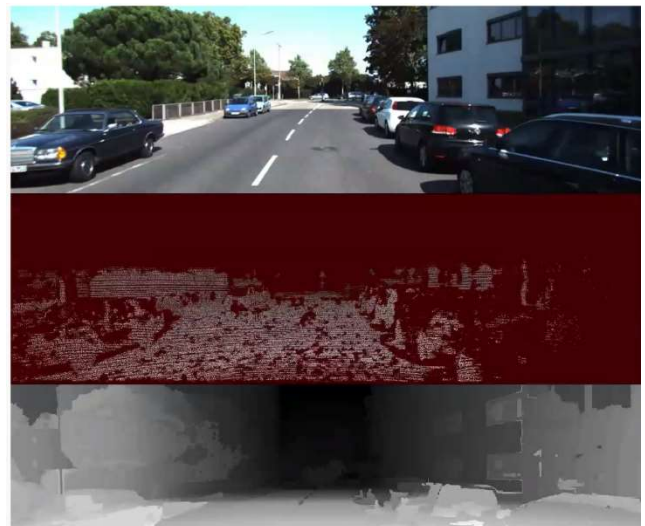
図 2 動画における one shot の RGB の frame 画像 (上 1/3 の部分) とこの frame において Lidar によって計測された距離の明暗 (256 階調) 画像 (上から 2 番目の 1/3 の部分) を示す。
