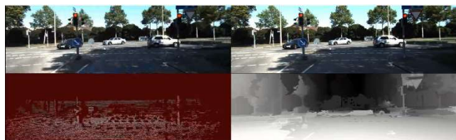
図3 動画における one shot の RGB の frame 画像 (左上上半分) とこの frame において Lidar によって計測された距離の明暗 (256 階調) 画像 (左下半分) と、動的視差法による距離画像 (右下半分) を示す。
