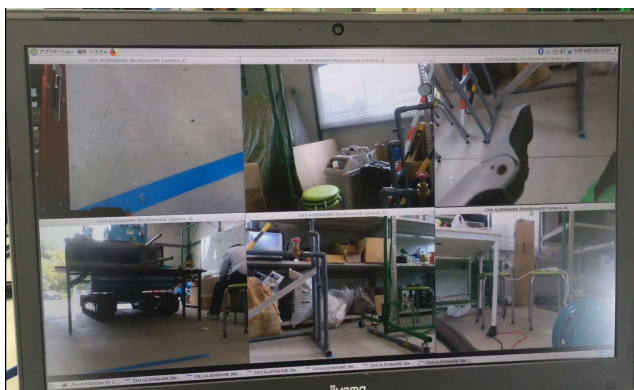
Fig. 3. Aizu Spider のカメラ映像表示画面 (DepthCamera:6. Resolution:640×480. Frame rate:30fps)
