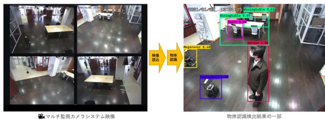
Fig.16 カメラの映像から物体認識を実施した結果
