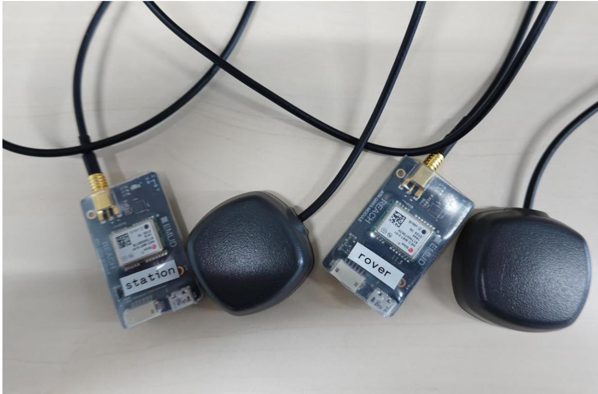
準備中のRTK-GNSS受信機とアンテナ
