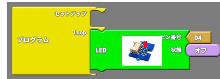
これらのプログラムは、状態がONの時はD4端子に5Vが出力されて、LEDが点灯する。
