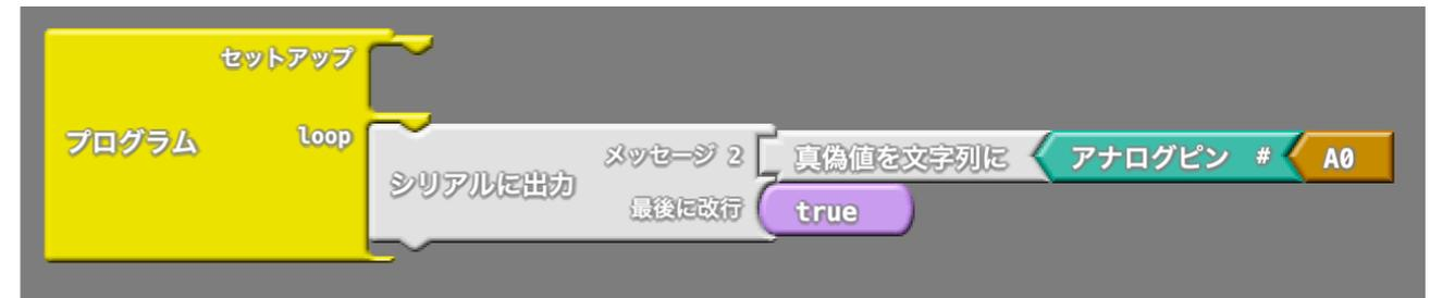
シリアルモニターで見ると数値が0~1023で変わるはずだ。それが0~5Vまでの電圧を1024段階で読み取った結果なんだよ。
