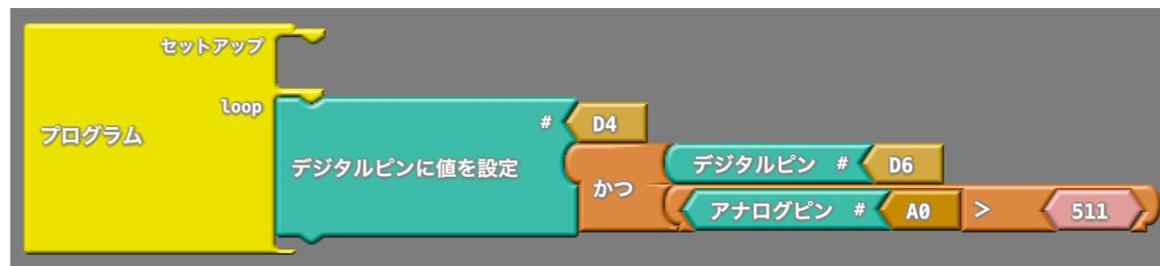
例えば、上のプログラムは、D6(スイッチ)が押された状態で、A0 (ポテンショナー) が左に回されて511を超えていないとD4(LED)が点灯しないんだ。
