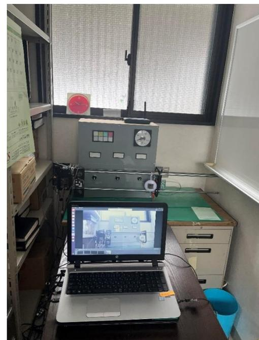
施設内の制御盤の遠隔監視・操作
