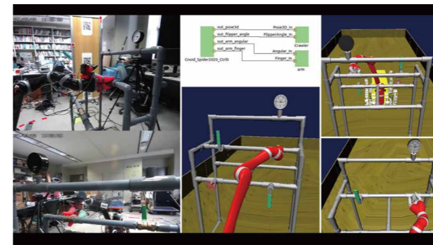
現実空間で採取したデータを仮想空間のロボットモデルに送信することで、振る舞いを再現。
