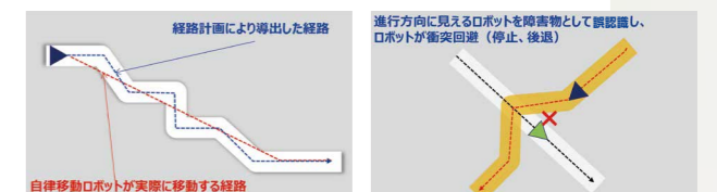
予測経路と実際の経路に誤差が生じた 前方にあるロボットを障害物として誤認識し、衝突回避動作が行われた
